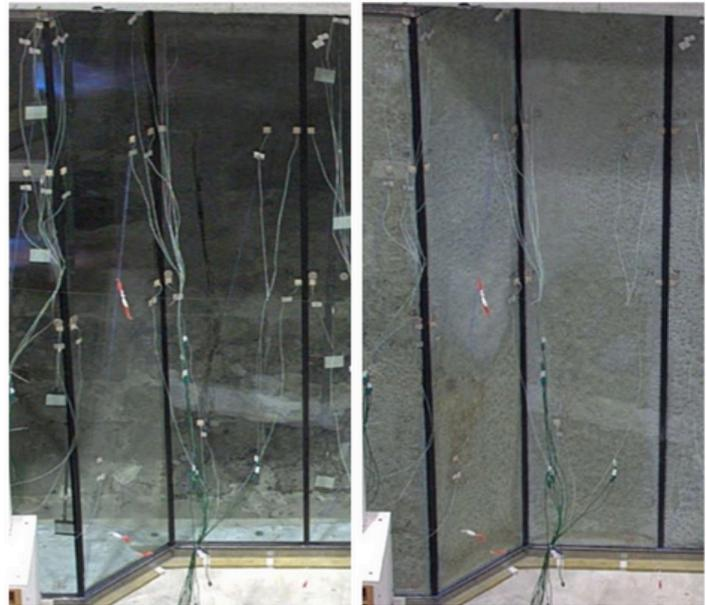
Dans le cadre de notre collaboration continue avec Forster Profile Systems, nous avons testé avec succès Pyroguard Infinity dans un cadre Forster Fuego Lite EI30, à l'échelle réelle, avec un assemblage à plat-joint de 45°.
