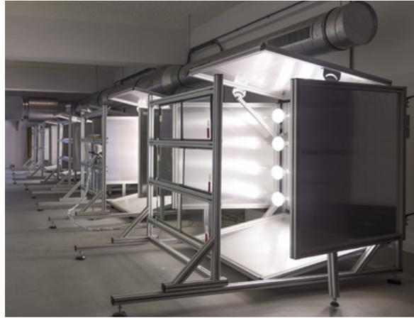
Pyroguard Protect, notre verre trempé coupe-feu, a été mis sous les projecteurs, révélant une durabilité exceptionnelle aux UV et offrant des résultats supérieurs aux exigences des normes d'essai EN 12543 et EN 14449.
