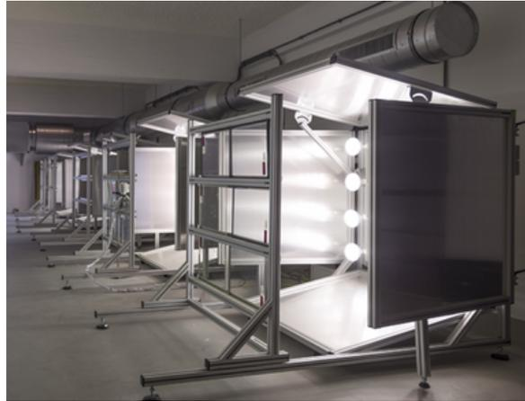
Pyroguard Protect, il nostro vetro temprato di sicurezza resistente al fuoco, è stato messo sotto i riflettori e ha rivelato un'eccezionale durata ai raggi UV, con risultati che superano i requisiti delle norme di prova EN 12543 e EN 14449.
