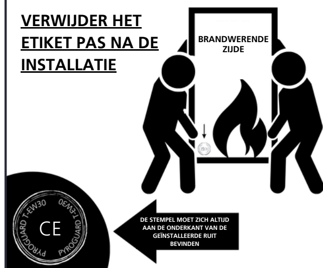
Afbeelding 1 Voorbeeld van installatie-etiket
