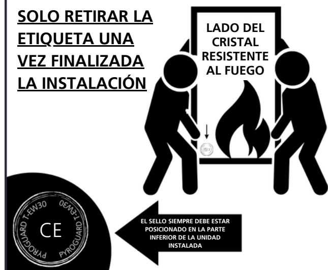
Figura 1 Ejemplo de instalación de la etiqueta
